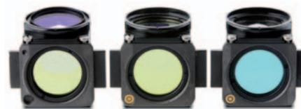
Es stehen 3 unterschiedliche Reflektormodule Z zur Verfügung, die mit je einem Anregungs- und Emissionsfilter und einem Farbteiler werkseitig bestückt werden:
