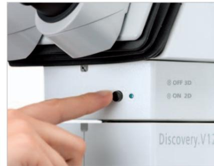
Bei der binokularen Beobachtung im Axial-Modus versetzen Sie das Objektiv per Knopfdruck mittig unter den rechten Kanal des Stereomikroskops. Die aktivierte Strahlenteilung erlaubt Ihnen die binokulare Beobachtung des nun zweidimensionalen, parallaxefreien mikroskopischen Bildes.
