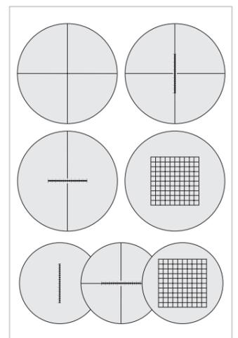
Okularplatten zum Messen, Zählen, Vergleichen (d=26 bzw. 21mm)
