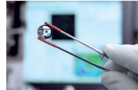
*Jede Linse wird vor dem Einbau gegen einen „Null-Linsensatz“ exakt vermessen. Diese Linsenwerte werden digital in einem Datenpool gespeichert – die Basis, auf der dann computerberechnete Kombinationen erstellt werden. So entsteht für jedes einzelne Mikroskop eine optimal aufeinander abgestimmte Linsen-Familie.*
