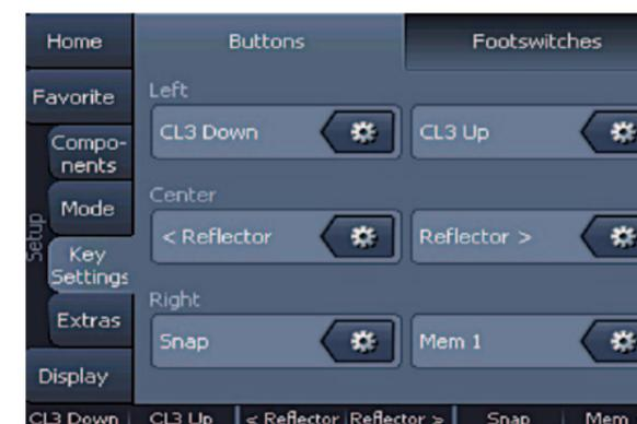
Programmieren Sie unterschiedliche Funktionen auf die drei Drucktasten-Paare. Die Funktionen sehen Sie auf der unteren Zeile des Displays. Gleiches gilt für die Fußregler: die entsprechende Seite rufen Sie durch Aktivieren der Registerkarte **Footswitches** auf.
