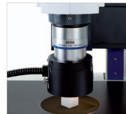
**Diffusor S ausziehbar, d=66mm**
