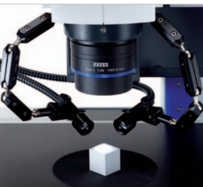
**Spot Beleuchtung, 2-seitig** – Variable Schrägbeleuchtung zur Reduzierung störender Schlagschatten
