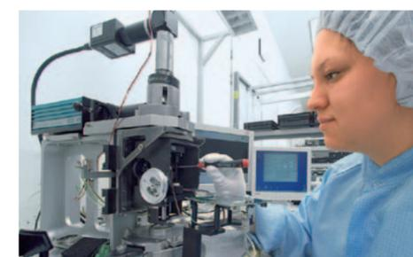
*An der Pankrat-Justiervorrichtung wird der präzise Ablauf aller beweglichen Optikglieder programmiert. Rund 7000 Stützstellen werden per Computer dafür ausgewertet. Jedes einzelne Stereomikroskop erhält so eine eigene Korrektur – eben seine ganz individuelle Zoomsteuerkurve.*
