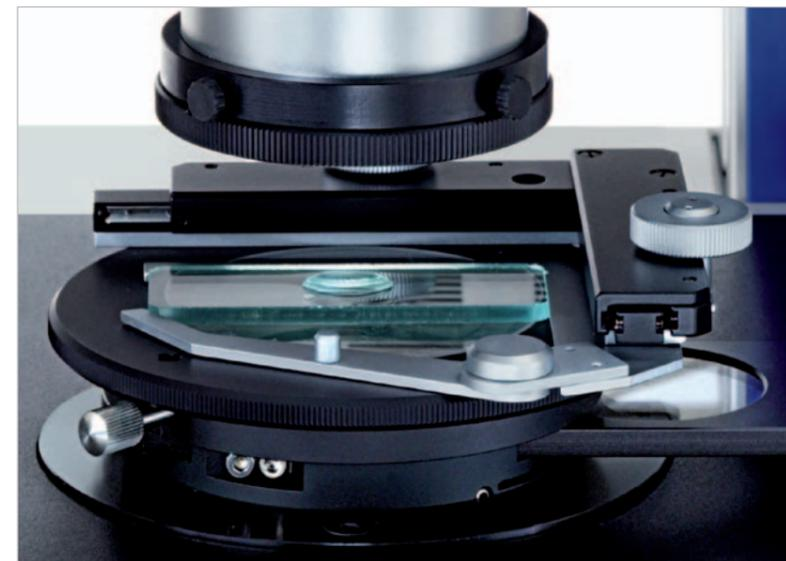
Für Durchlichtuntersuchungen im polarisierten Licht besitzt der Drehtisch Pol eine Aufnahme für den **Polarisator S** und kann auf Wunsch mit einem Objektführer und einer **Lambda-Platte im Schieber** (Rot 1. Ordnung) ausgestattet werden.
