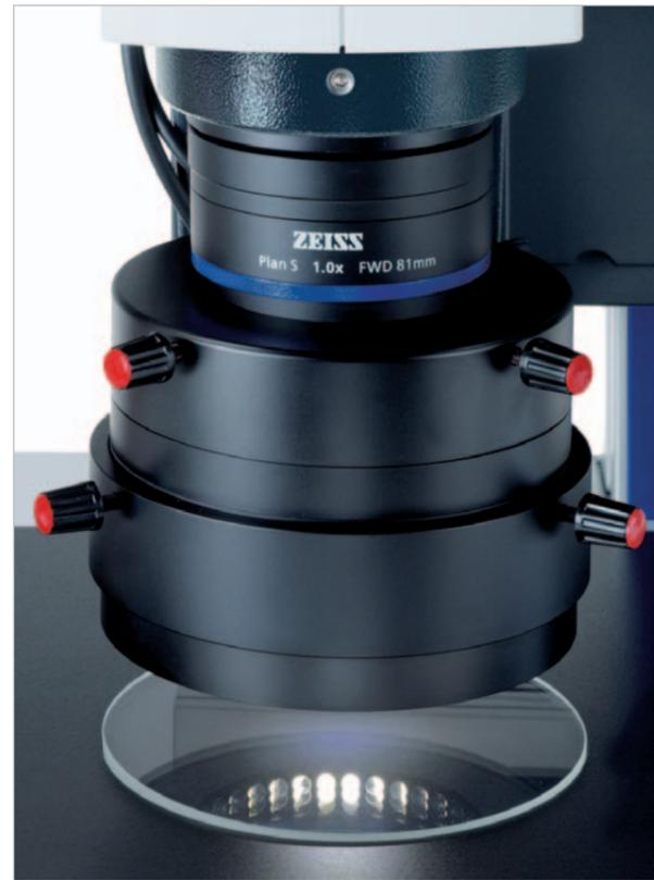
Zur Kombination von Hell- und Dunkelfeld im Auflicht montieren Sie über einen speziellen Adapter das **VisiLED Ringlicht S 40-10 DF** an das Hellfeld-Ringlicht.
