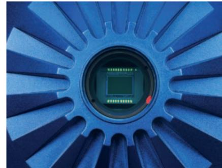
Ein Merkmal der AxioCam Kameras: gekapselter Sensor mit C-Mount Anschluss.
