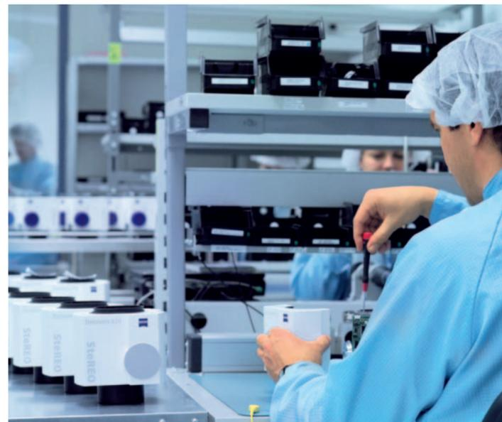
*Schnell, flexibel, effektiv: die Endmontage der Stereomikroskope SteREO Discovery in den Reinräumen der Carl Zeiss Microscopy GmbH in Jena. Sie erfolgt als „Einzelstück-Fließfertigung nach Wertstrom-Designkriterien“.*
