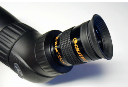
▲ Abb. 3: Alternativ können auch eigene 1/4-Zoll-Astrookulare verwendet werden.
