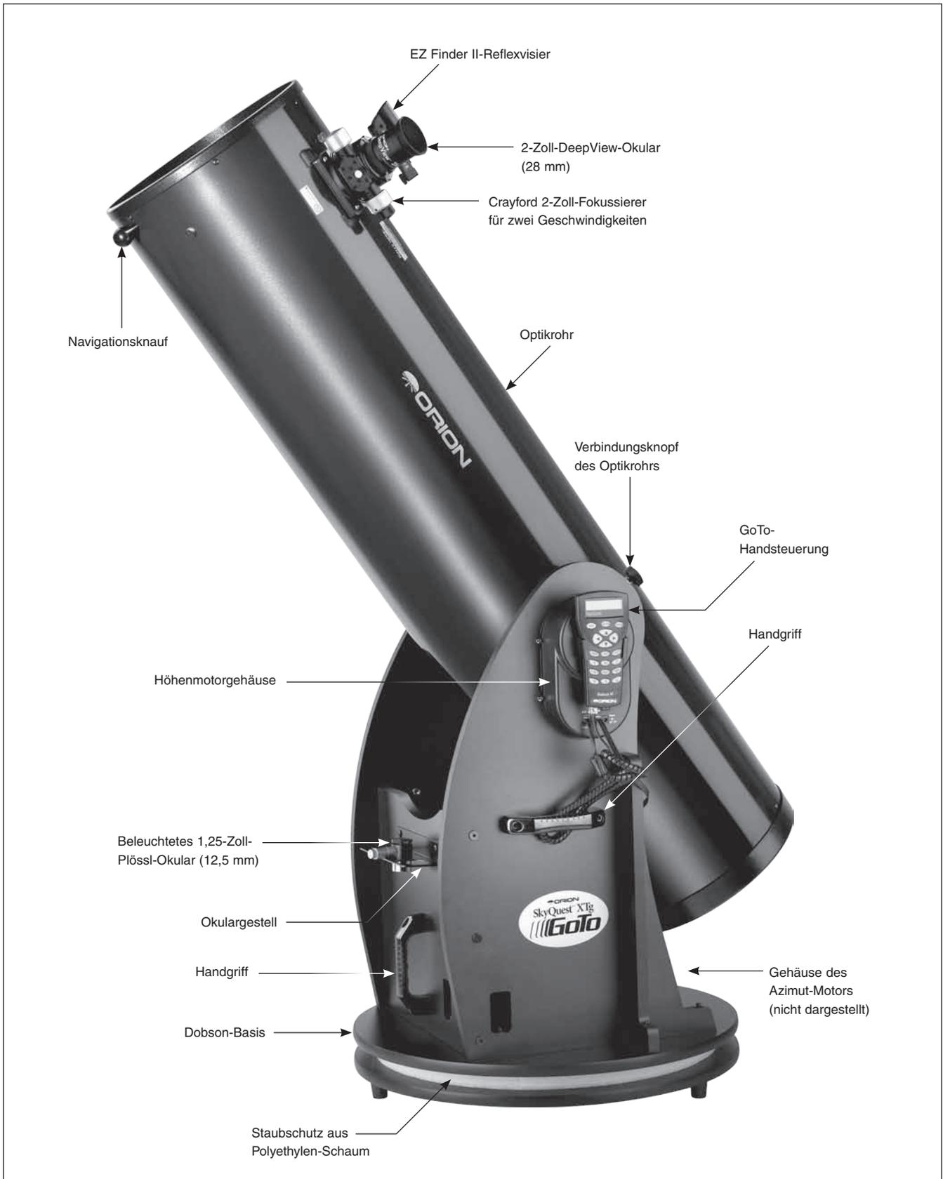
**Abbildung 1.** Übersicht über das SkyQuest XTG Dobson (Darstellung: 12-Zoll-Modell)
