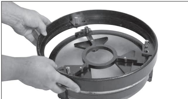
**Abbildung 14.** Senken Sie den hinteren Endring auf die Spiegelzelle ab, sodass die Gewindeschäfte durch den Endring passieren, und der Endring auf den Federn ruht.
