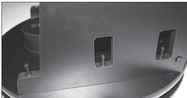
**Figure 11.** Assemblage de la base avec les vis placées mais non serrées.
