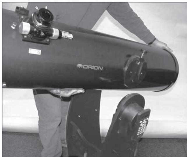
**Figure 18.** Prenez le tube de télescope comme sur la figure, par l'anneau d'extrémité arrière d'une main et l'autre main sous le tube, et posez-le doucement de sorte que le côté de la queue d'aronde se place sur le tourillon métallique situé sur le panneau latéral gauche.
