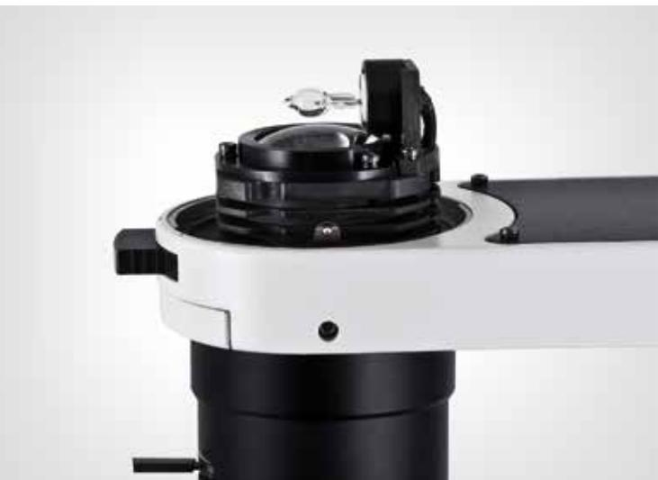
L'AE2000 répond également aux exigences les plus récentes d'éclairage à LED par **un simple remplacement de l'ampoule halogène par un petit module LED**. L'un des avantages principaux de la LED, l'extrême réduction du dégagement de chaleur, peut désormais être obtenu pour l'étude essentielle de spécimens vivants.
