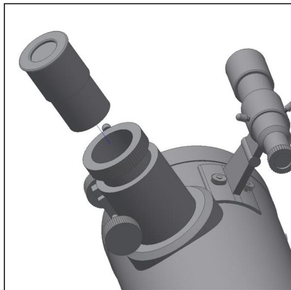
Figure 9. fixation de l'oculaire.
