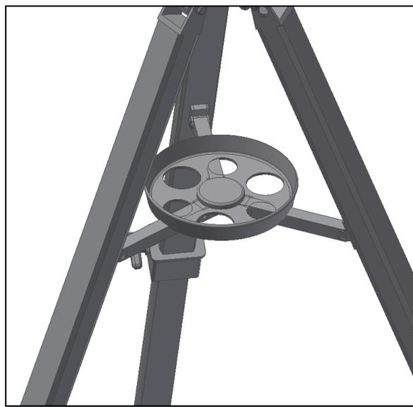
Figure 3. Mise en place de la tablette porte-accessoires
