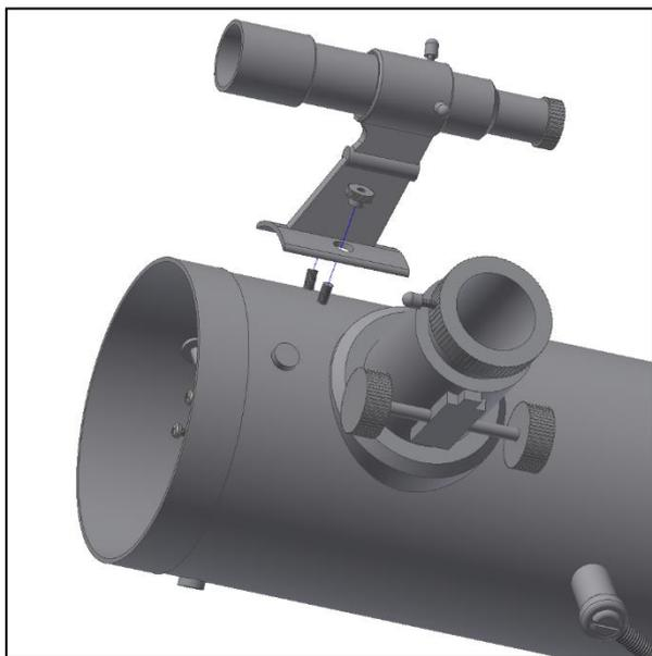
Figure 8. fixation du chercheur.
