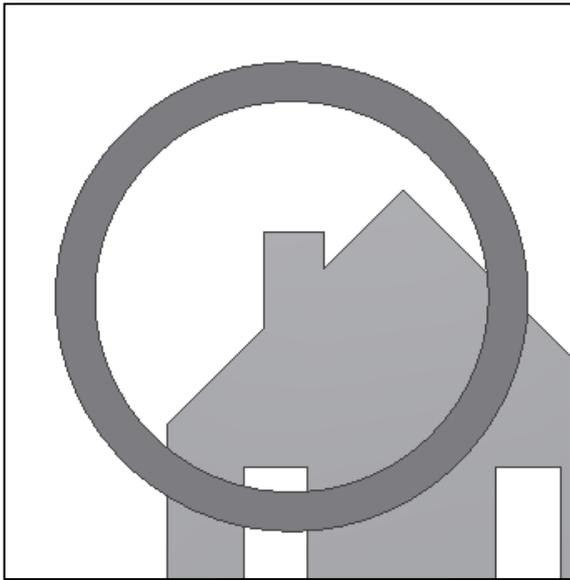
**4.2.1.** Un objet éloigné est centré dans le champ de vision du télescope. Dans cet exemple, on voit une maison avec une cheminée. La cheminée est le point de repère à placer au centre du champ de vision. Vous devez d'abord regarder à travers le télescope avec le plus faible grossissement (utilisez de préférence l'H20 mm) afin d'avoir le champ de vision le plus large.
