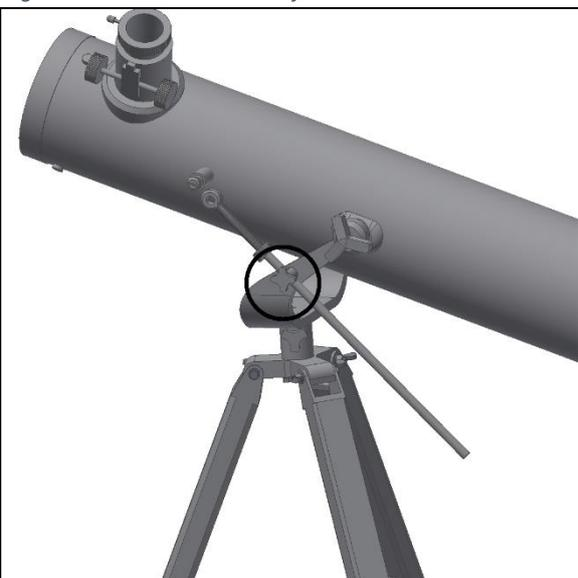
Figure 6. Insérez la tige azimutale..
