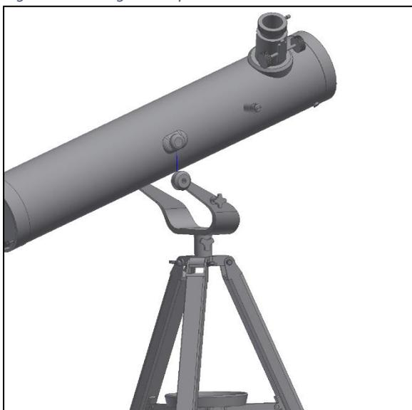
Figure 4. Placez le tube sur la fourche.
