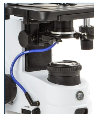
● Cardioid Dunkelfeld Kondensator mit integrierten 5 W LED-Lichtquelle und internen 100-240 V Netzteil
