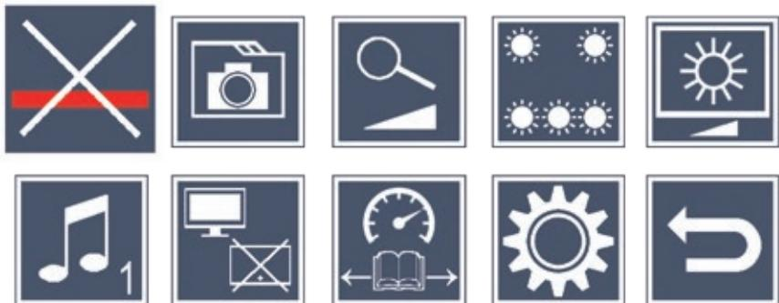
Vælg de enkelte symboler, som har de efterfølgende beskrevne funktioner, med de to rulleknapper (1, 8). Symbolet for den valgte funktion vises lidt større og delvist fremhævet med farver. For at aktivere eller deaktivere den ønskede funktion eller åbne en gemt undermenu skal du trykke på -knappen (17). Funktionerne styres også med de angivne knapper i undermenuerne.
