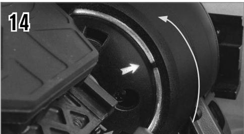
Richten Sie den Pfeil auf dem Dock mit der Ausrichtungsmarkierung auf der Montierung aus und drücken Sie das Dock nach innen, während Sie es gegen den Uhrzeigersinn drehen, bis der orangefarbene Entriegelungsknopf in der Öffnung am Dock einrastet.
