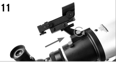
Faites glisser le support du chercheur dans le rail de queue d'aronde sur le tube du télescope, à proximité du système de mise au point. La plus grande fenêtre du chercheur doit être orientée vers l'avant du télescope. Fixez le support en serrant la vis de fixation sur le rail de queue d'aronde.
