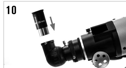
Setzen Sie die Steckhülse des 25-mm-Eyepiece in den Zenitspiegel ein und ziehen Sie die Stellschrauben fest.
