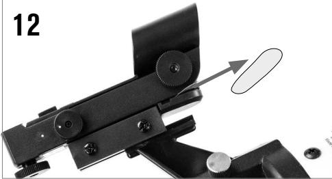
Zwischen Batterie und Kontakt befindet sich ein kleiner durchsichtiger Kunststoff-Abstandshalter. Dieser wurde eingesetzt, um während des Versands ein Entladen der Batterie zu verhindern. Ziehen Sie diesen Abstandshalter zur Inbetriebnahme der Batterie heraus.
