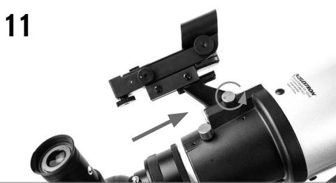
Schieben Sie die Sucherfernrohrhalterung in den Schwabenschwanzschlitz am Teleskopstutus in der Nähe des Fokussierers. Das große Fenster am Sucherfernrohr muss zur Vorderseite des Teleskops zeigen. Befestigen Sie die Halterung, indem Sie die Stellschraube am Schwabenschwanzschlitz festziehen.
