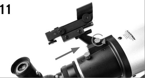
Far scorrere la staffa del cercatore nella scanalatura a coda di rondine sul tubo del telescopio vicino al focheggiatore. L'ampia finestrella del cercatore dovrebbe essere rivolta verso la parte anteriore del telescopio. Fissare la staffa serrando la vite sulla scanalatura a coda di rondine.
