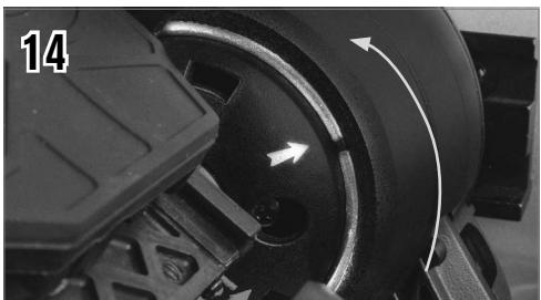
Alignez la flèche sur le support avec la marque d'alignement sur la monture et appuyez dessus tout en faisant tourner le support dans le sens inverse des aiguilles d'une montre jusqu'à ce que le bouton de libération s'enclenche dans le trou du support.
