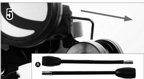
Um die Feineinstellungsregler **A** an Ihrer Montierung zu befestigen, suchen Sie zuerst den mitgelieferten Inbusschlüssel, der im Schlitz auf der Vorderseite Ihrer Montierung versteckt ist.
