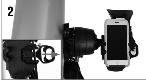
Ouvrez la glissière à ressort située sur le dessus du support de téléphone et installez le téléphone pour qu'il soit à niveau sur le rebord du bas du support de téléphone. Relâchez la glissière en douceur pour maintenir le téléphone en place. La plupart des téléphones pourront être placés dans le support avec leur étui. Il peut cependant être nécessaire de retirer l'étui de votre téléphone, s'il est spécialement épais ou qu'il n'est pas compatible avec la pince (par ex. les étuis de type folio).
