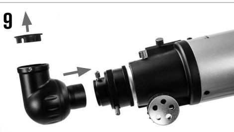
Nehmen Sie den Zenitspiegel für aufrechtes Bild und entfernen Sie die Kunststoffabdeckungen. Setzen Sie die Steckhülse des Zenitspiegels in den Fokussierer ein und sichern sie ihn durch Anziehen der Stellschrauben.
