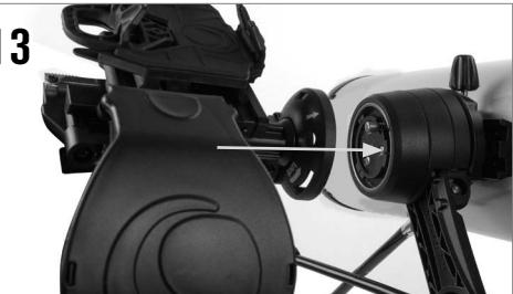
Para instalar el conector de teléfono StarSense, introduzca el soporte de bayoneta en el lateral del conector, en el puerto del lateral del soporte al otro lado de la fijación machihembrada.
