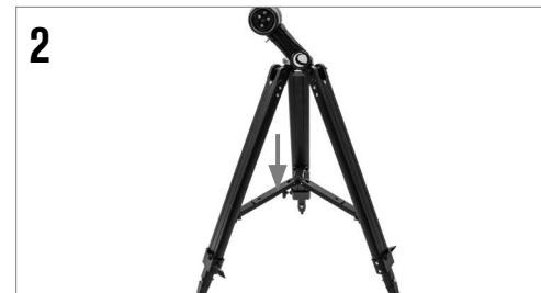
Zum Aufbau des Stativs die Beine nach außen ziehen, bis sie vollständig ausgezogen sind. Drücken Sie die mittlere Beinstrebe nach unten.
