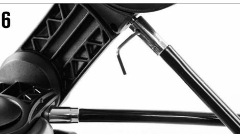
Installez la molette de contrôle de mouvement ralenti sur le moyeu d'engrenage en D et appuyez dessus pour vous assurer qu'elle est complètement enfoncee. Utilisez la clef hexagonale pour serrer les vis de fixation sur la tige de l'engrenage. Remettez la clef hexagonale dans son logement sur l'avant de la monture.
