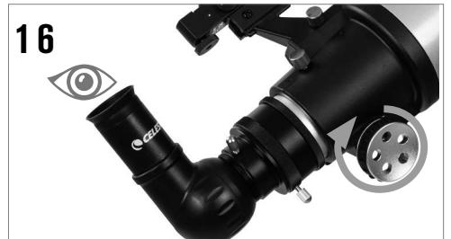
Nehmen Sie den Objektivdeckel vorne am Teleskop ab. Schauen Sie zum Beobachten durch das Okular, wie oben dargestellt. Stellen Sie das Bild scharf, indem Sie die Knöpfe unterhalb des Fokussierers drehen.
