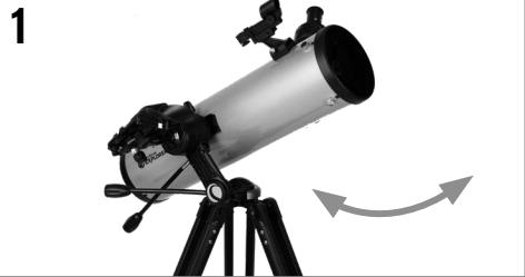
La monture StarSense Explorer DX dispose de freins de mouvement sur chaque axe. Pour effectuer de larges mouvements avec le télescope, tenez simplement un pied du trépied d'une main, et de l'autre, poussez le tube du télescope dans la direction opposée.
