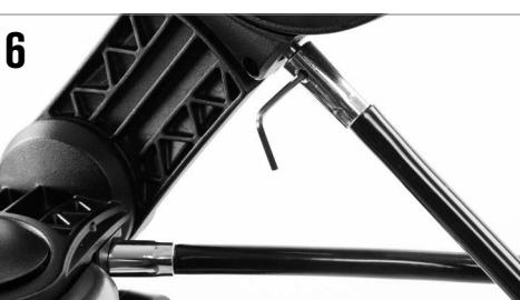
Setzen Sie den Feineinstellungsregler auf die D-förmige Getriebewelle und drücken Sie ihn nach innen, um sicherzustellen, dass er fest sitzt. Ziehen Sie die Stellschrauben mit dem Inbusschlüssel auf der Getriebewelle fest. Stecken Sie den Inbusschlüssel wieder in seinen Aufbewahrungsort auf der Vorderseite der Montierung.
