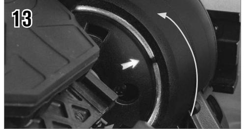
Alignez la flèche sur le support avec la marque d'alignement sur la monture et appuyez dessus tout en faisant tourner le support dans le sens inverse des aiguilles d'une montre jusqu'à ce que le bouton de libération s'enclenche dans le trou du support.
