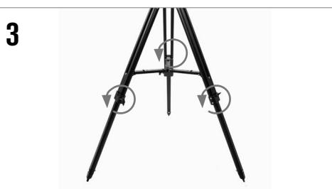
Ziehen Sie die Beine des Statisv heraus, indem Sie die drei Knöpfe an jedem Bein lösen. Ziehen Sie jeden unteren Beinabschnitt ganz heraus und ziehen Sie die Knöpfe fest, um die Beine zu sichern.
