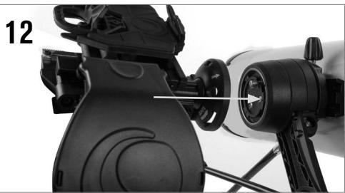
Per installare l'aggancio per telefono StarSense, inserire la montatura a baionetta a lato dell'aggancio nella porta a lato della montatura sul lato opposto al fermo a coda di rondine.
