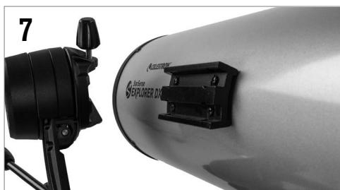
Tenez le tube du télescope à côté de la monture, la barre à queue d'aronde sur le tube orientée vers le rail situé sur le dessus du bras de monture.
