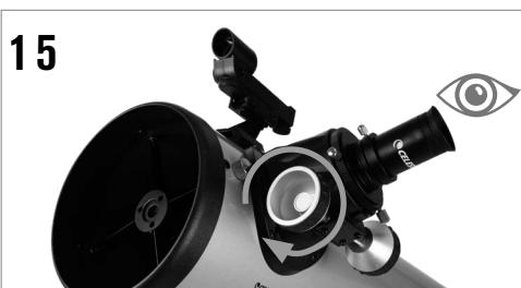
Retirez le capuchon de la lentille de l'avant du télescope. Pour effectuer l'observation, regardez dans l'oculaire comme illustré ci-dessus. Faites le point sur l'image en faisant tourner les molettes sous le système de mise au point.
