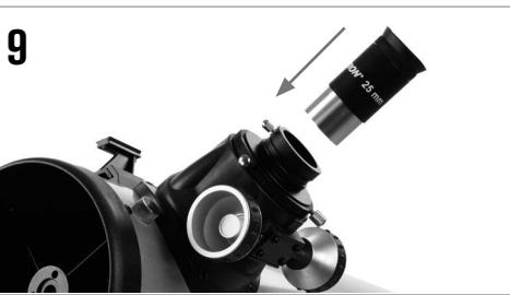
Entfernen Sie die Kappe vom Fokussierer und setzen Sie die Steckhülse des 25-mm-Okulars in den Fokussierer ein. Ziehen Sie die Stellschraube wieder fest, um das Okular zu fixieren.
