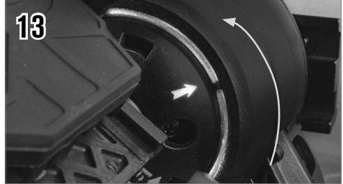
Alinee la flecha del conector con la marca de alineación del soporte y presione hacia dentro girando el conector en sentido contrario a las agujas del reloj hasta que el botón de liberación naranja encaje en posición en el agujero del conector.
