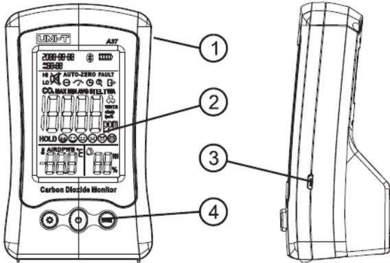
① : boîtier ② : écran LCD ③ : port USB ④ : boutons de commande
