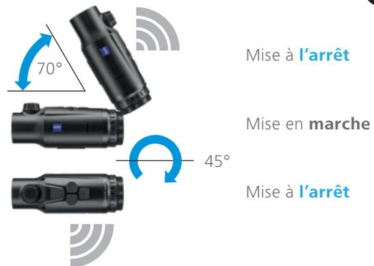
Le capteur d'angle détecte automatiquement la position exacte de la ZEISS DTC 3 et active le mode veille à un angle latéral de 45° et à un angle de 70° vers le bas ou vers le haut. L'appareil quitte automatiquement le mode veille lorsque le chasseur ramène l'arme en position de tir.
