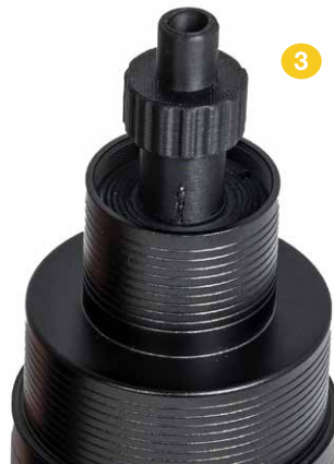
Bild 2: Schrauben Sie den Vorspannung heraus, indem Sie das kleine Werkzeug ( 3 ) senkrecht auf den Vorspannung setzen. So kann es den eigentlichen Filter nicht berühren.
