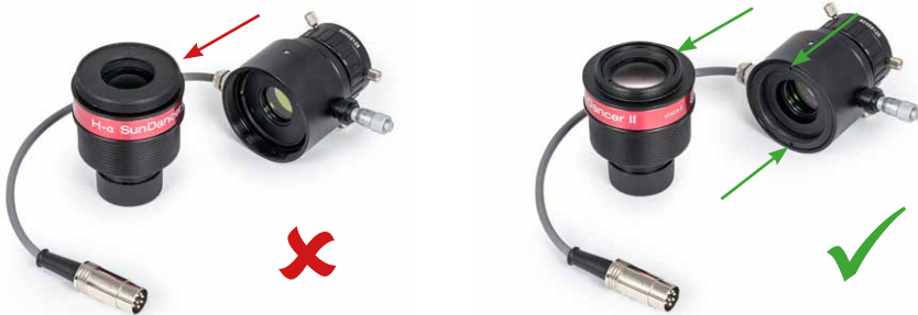
Bild 1: Schrauben Sie die TZ-3S vom SunDancer II H-alpha-Filter ab. Achten Sie darauf, dass der Reduzierring auf T-2 im H-alpha-Filter verbleibt.
