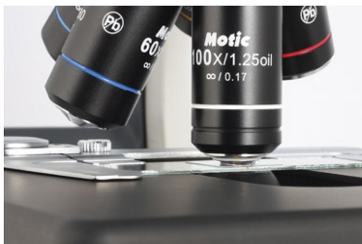
▲ Les objectifs avec une petite distance de travail (40X, 60X) qui sont montés à proximité de l'objectif 100X ont ainsi un risque élevé de contamination par l'huile d'immersion. Un nettoyage préventif est recommandé pour ces objectifs.
