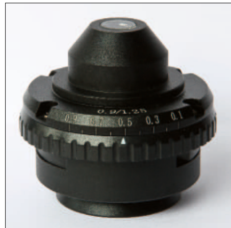
Abbildung 3.4 Kondensor des Motic BA310E mit direkter Größenangabe der Aperturblende.
